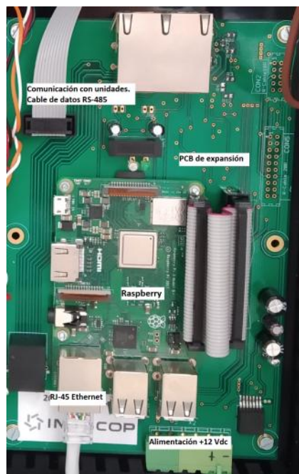
Figura 14: Raspberry alojada en tarjeta de expansión
