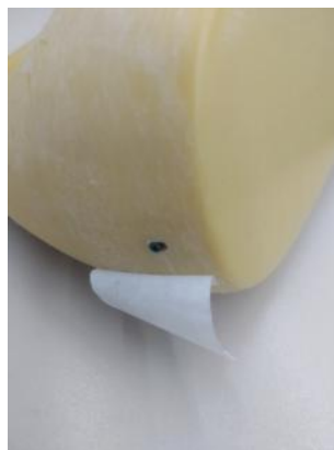
Figura 1 y 2: Tags comerciales de diferentes tipos, geometrías y potencia (izqda.) Marcador implementado en el talón de una horma (dcha.)
