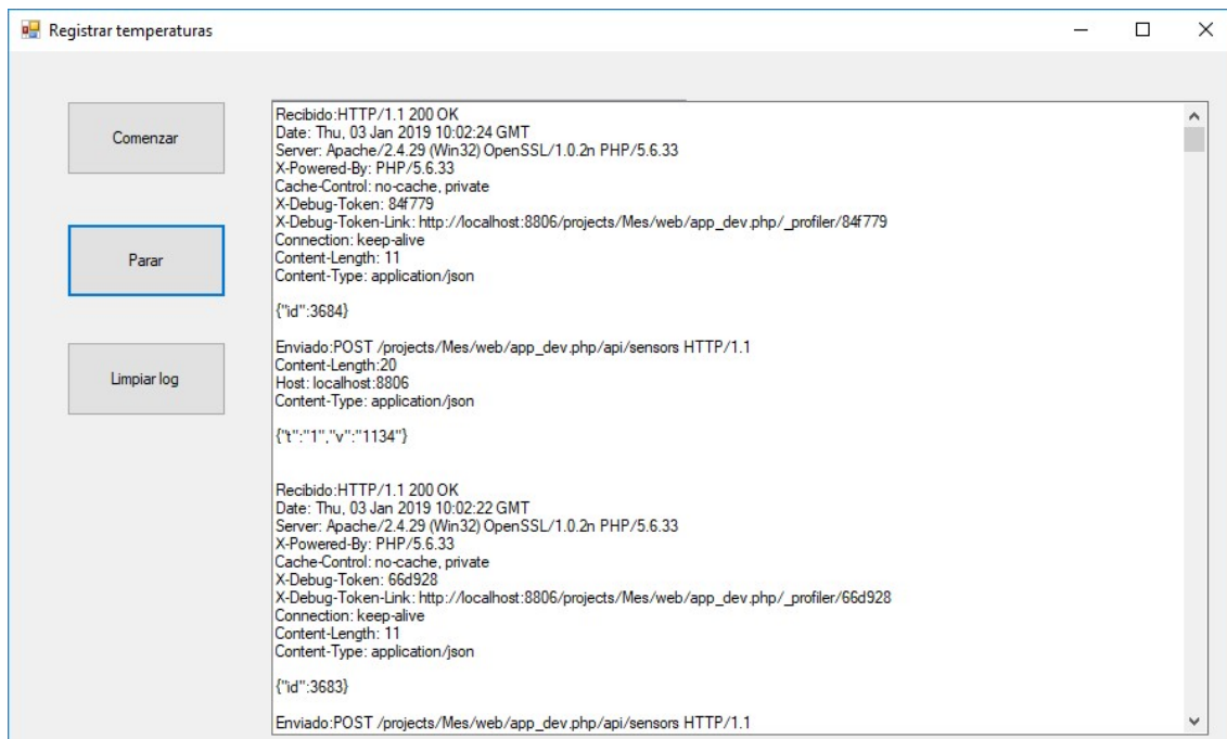
Imagen 3: Datos enviados al servidor de representación de datos por el software de simulación
