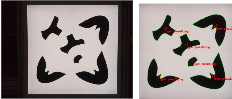
Fig. 14. Ejemplo de identificación de piezas. Imagen original (dch) y piezas identificadas y localizadas (izq)
