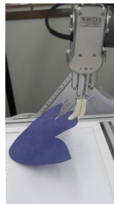
Fig. 4. Efecto de descuelgue en pieza sujeta por un solo punto.
