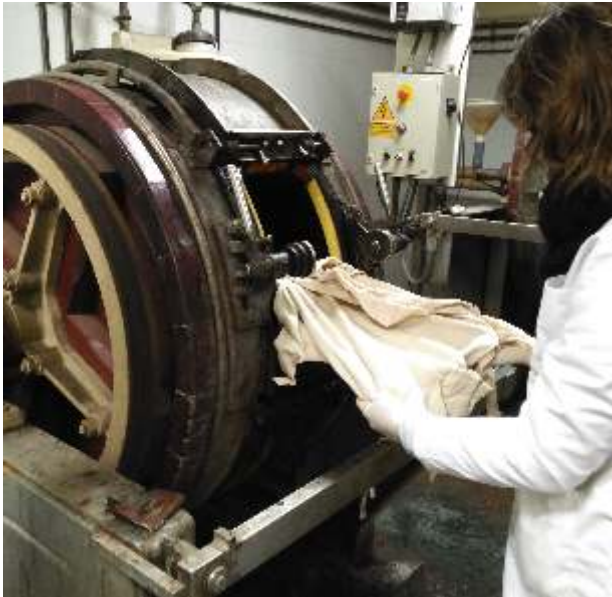
Figura 4: Aplicación de productos antioxidantes sobre piel en bombo
