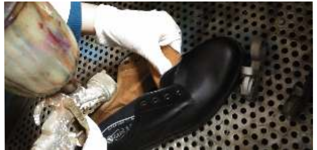
Figura 5: Aplicación de productos antioxidantes sobre calzado con pistola
