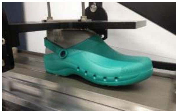
Figura 1: Ensayo de deslizamiento de calzado según norma EN ISO 13287
