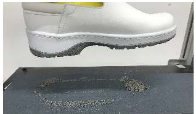
Figura 3: Nuevo prototipo de desgaste acelerado del calzado
