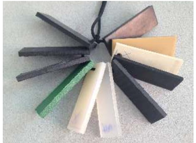
Figura 4: Muestras de probetas estudiadas como alternativas al Slider de referencia de la norma
