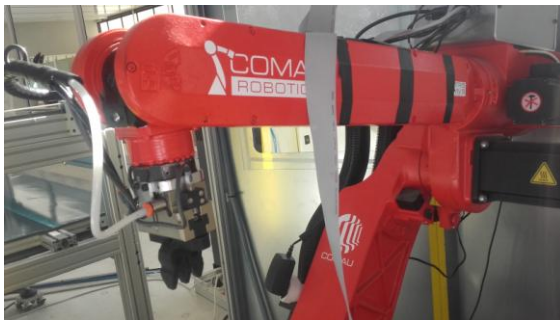
Figura 13: Acoplamiento garra con pinza SHUNCK en robot COMAU
