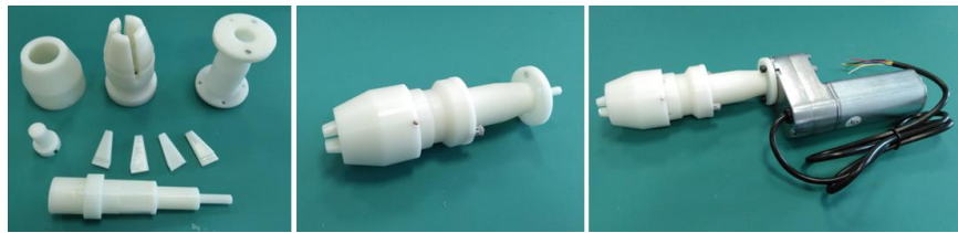
Figura 2: Sistema de agarre bidireccional fabricado en SLA.
