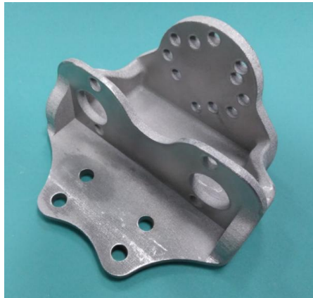
Figura 10: Brida acoplamiento multirobot construida en titanio (SL)
