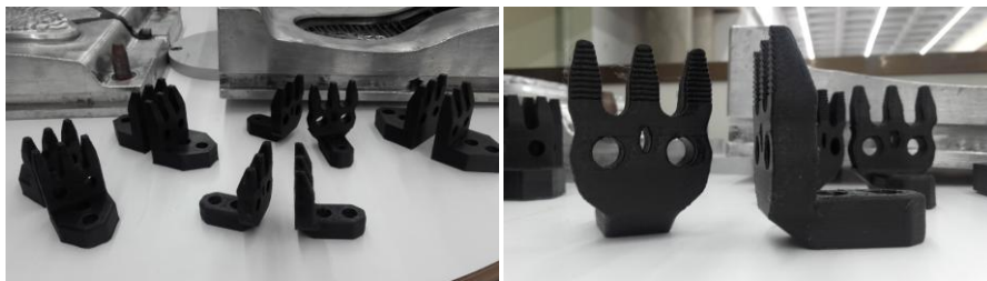
Figura 5: Prototipos de garras construidas por fabricación aditiva (FDM)
