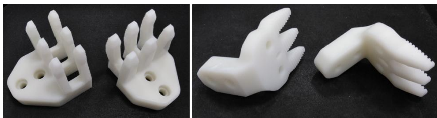
Figura 3: Garras dobles y simples fabricadas en SLA.
