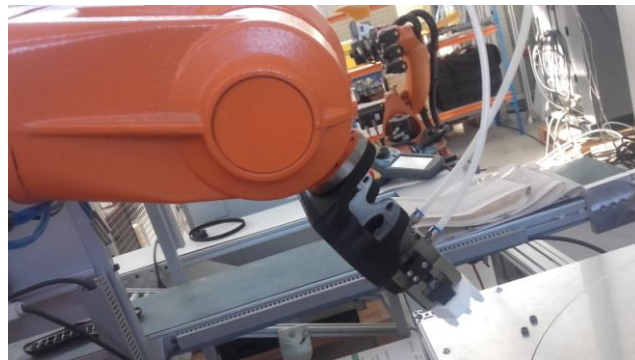
Figura 14: Acoplamiento garra con pinza SHUNCK en robot ABB
