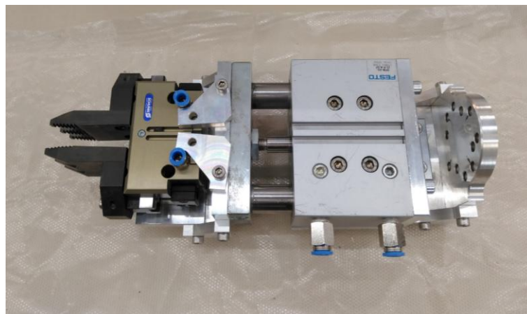
Figura 12: Prototipo de agarre y extracción completo por mecanizado convencional.
