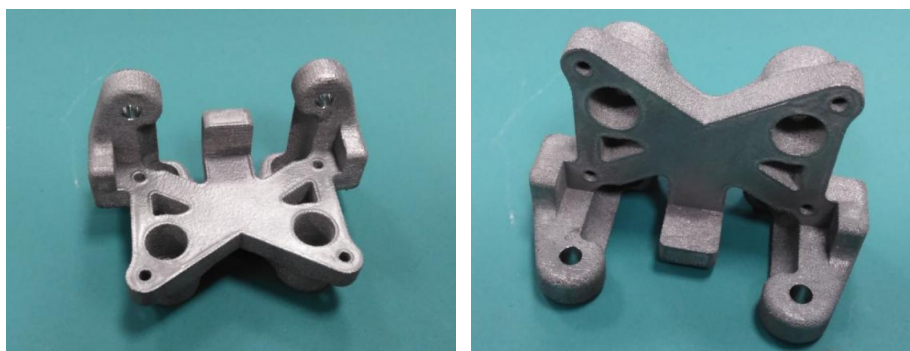
Figura 9: Brida para pinza SCHUNCK construida en titanio (SL)
