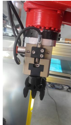
Figura 13: Acoplamiento garra con pinza SHUNCK en robot COMAU
