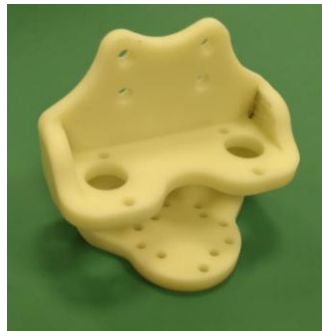
Figura 7: Brida de unión cilindro-robot fabricada en resina.
