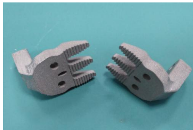
Figura 8: Prototipos de garras construidas en titanio por sinterizado láser
