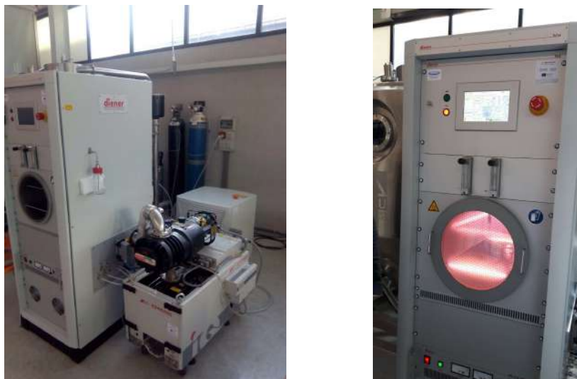
Figura 3. Sistema de tratamiento superficial por plasma a baja presión utilizado.
