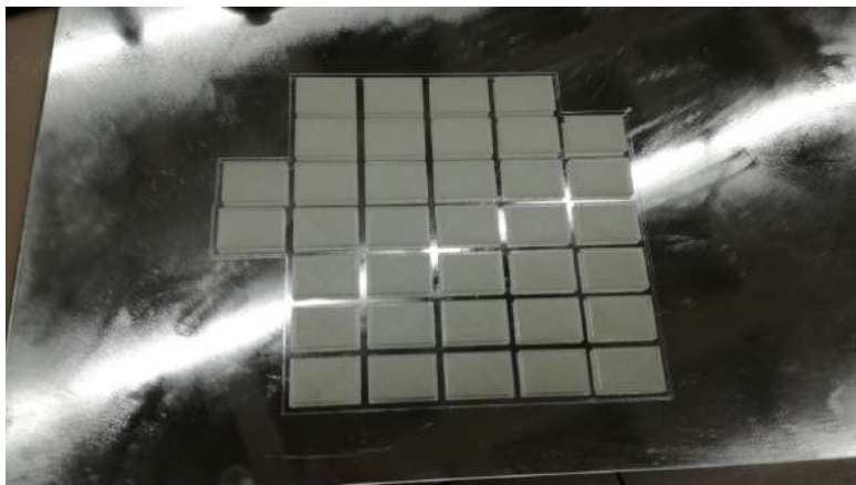
Figura 1. Probetas de poliuretano termoplástico obtenidas mediante impresión 3D.
