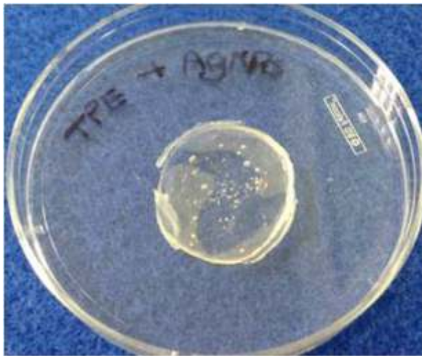
Figura 5: Probeta de material termofusible con nanopartículas de plata
