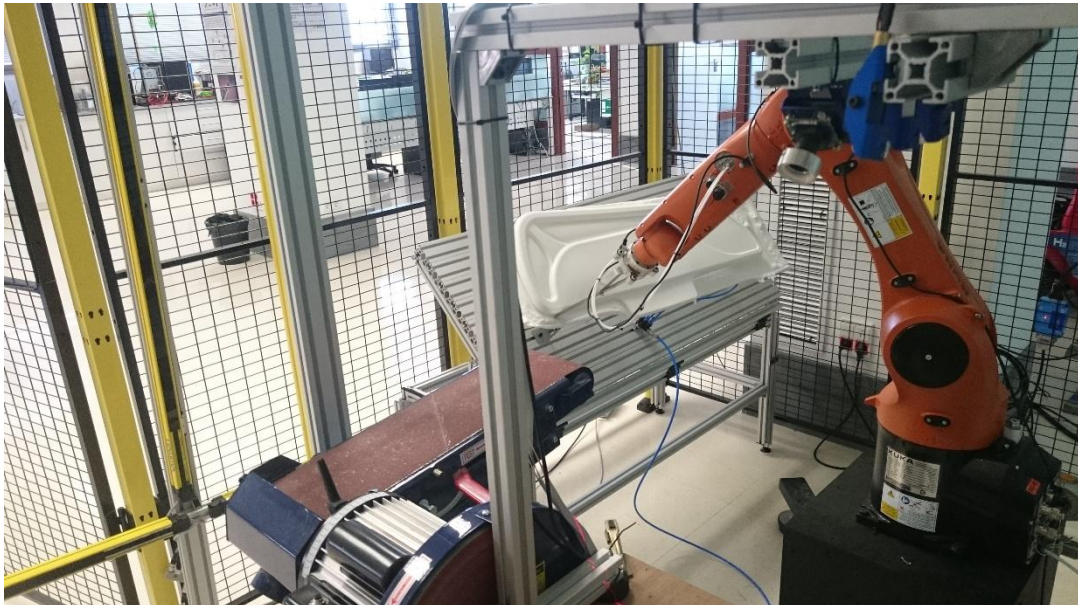
Figura 25: Corte de rebabas de gran tamaño con cuchilla.
