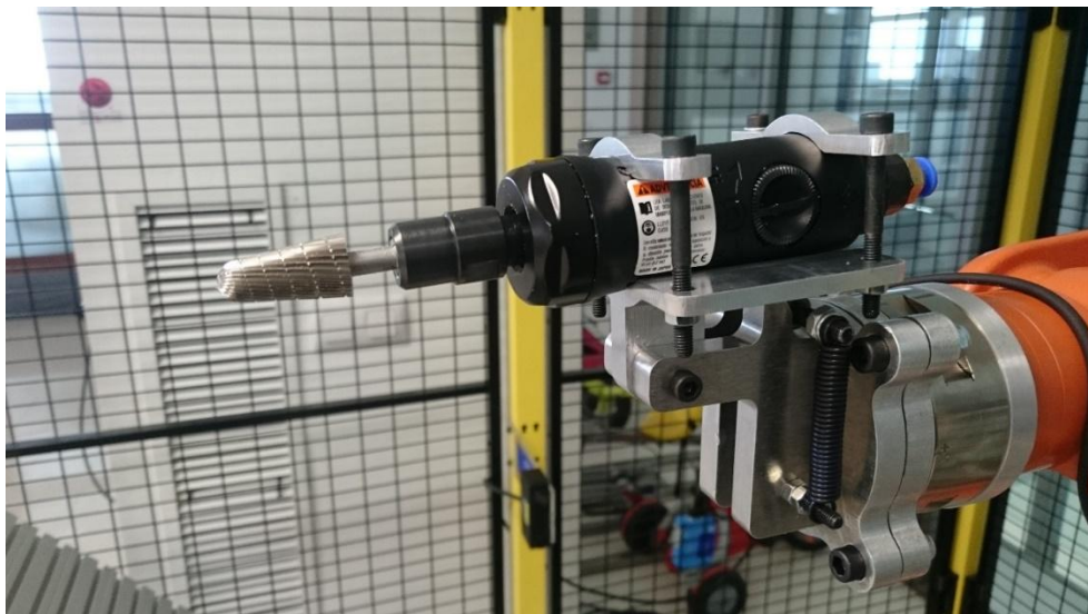
Figura 12: Montaje de herramienta de trabajo.
