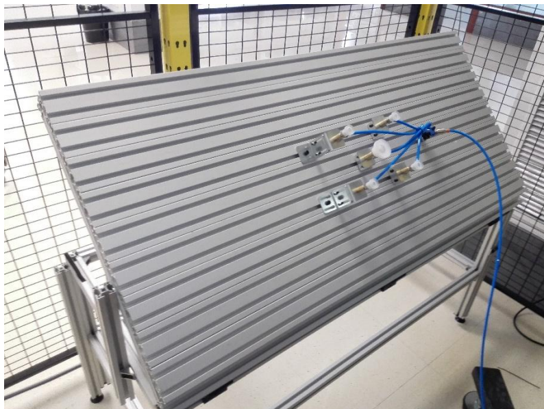
Figura 14: Montaje de ventosas en banco de trabajo.
