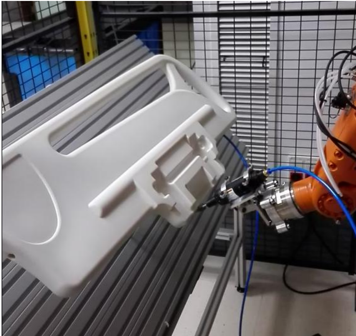
Figura 26: Montaje de sistema para desbarbado de piezas laterales de cama.
