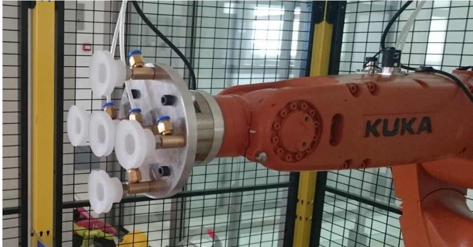
Figura 13: Montaje de herramienta para manipulación de piezas
