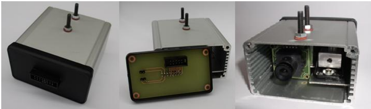
Figura 4: Cámara y láser en el interior del perfilómetro.
