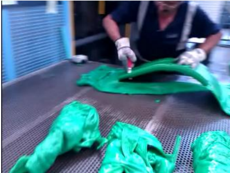
Figura 6: Recorte de rebabas con cuchilla.
