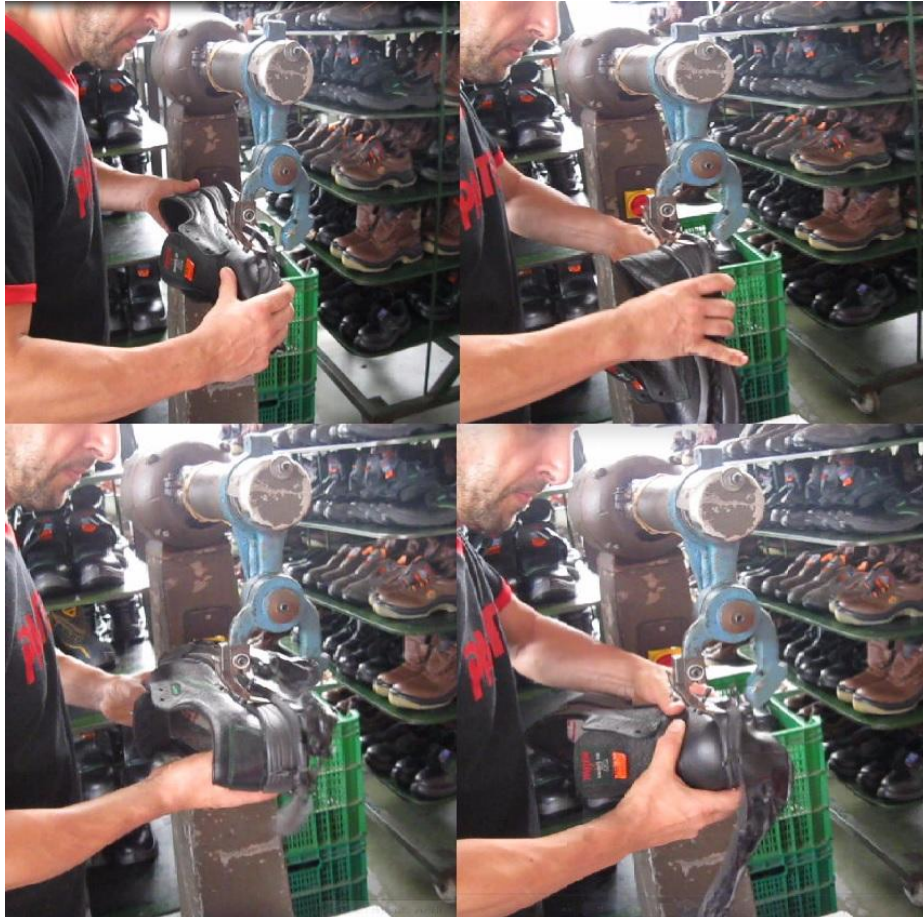
Figura 11: Eliminación manual de rebabas.
