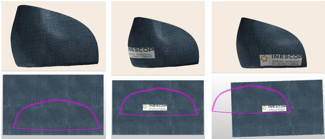
Fig.8: En primer lugar, tenemos la textura original sobre la pieza; en segundo, la pieza con la textura con el logo incorporado. En la tercera, basándonos en la referencia del aplanado, hemos colocado el logo en el lugar adecuado
