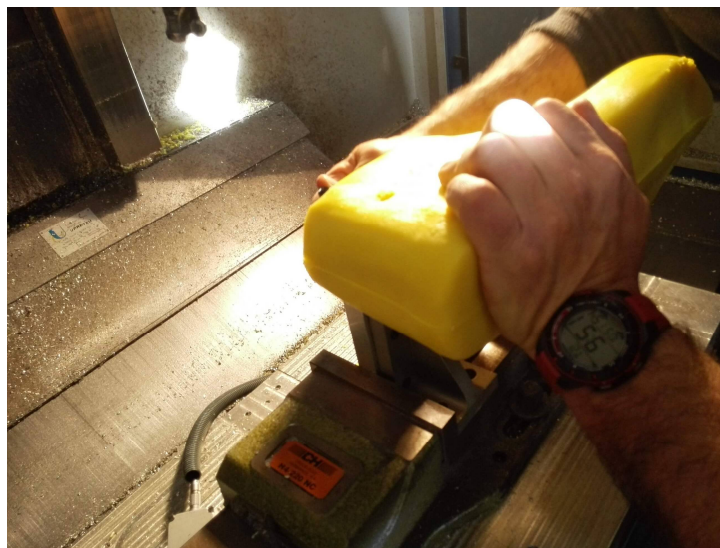
Figura 08.- Imagen del momento de colocación del bloque para mecanizado de hormas
