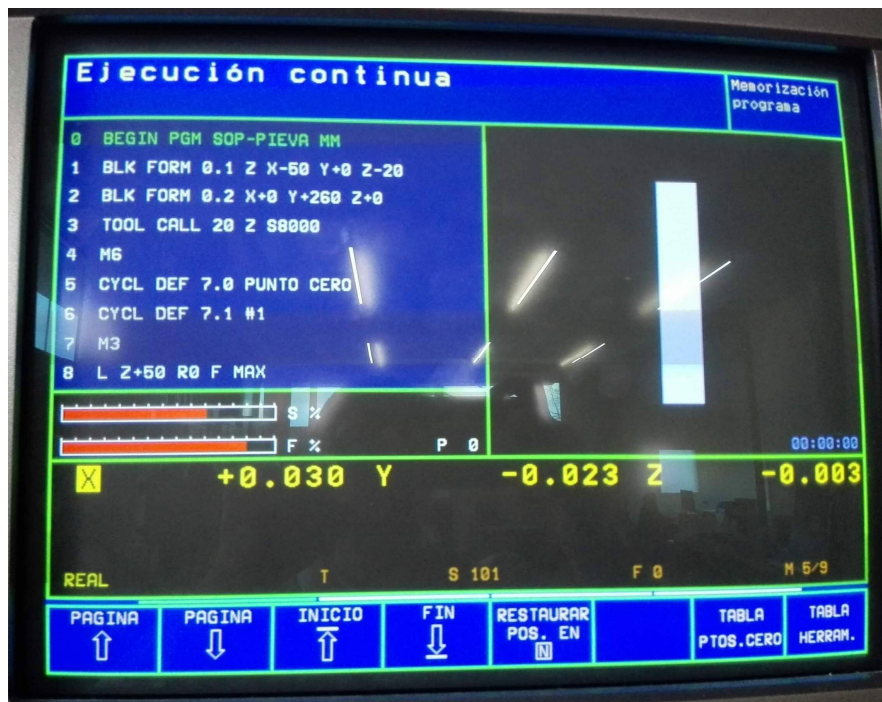
Figura 12.- Detalle del programa en el centro de mecanizado
