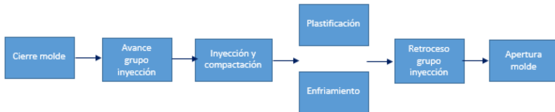
Imagen 4: Diagrama del ciclo de inyección
