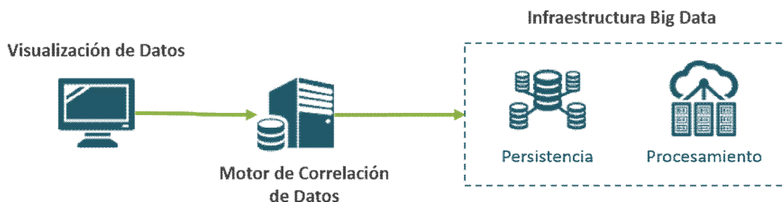
Figura 1: Arquitectura del Sistema de Optimización
