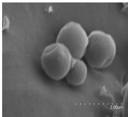
Microcápsulas con cubierta de ácido palmítico y ácido esteárico
