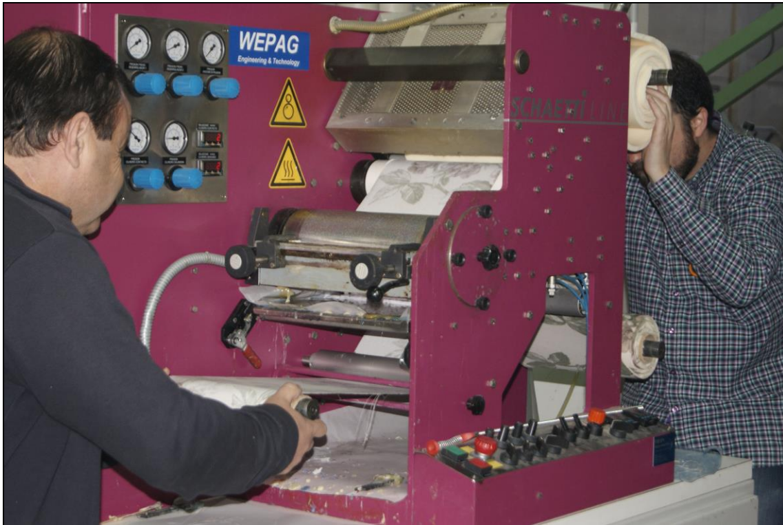
Laminación tejido tapicería con espuma (materiales AIDIMME) con adhesivos INESCOP y AITEX, empleando la laminadora hotmelt dot coating de AITEX.
