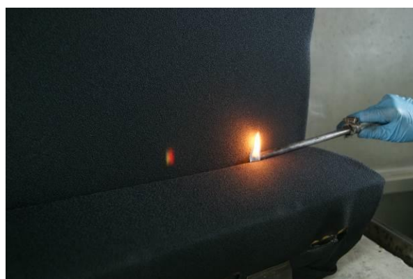
Figura 23. Aplicación de la llama (cerilla) en la estructura de asiento (tejido 2/espuma ignífuga)
