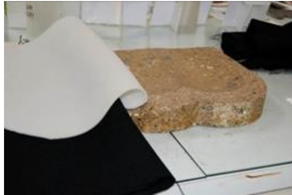
Figura 11. Estructura en forma de asiento o culote sobre el que se aplica adhesivo PUR reactivo para el encolado de lámina de espuma y tejido 2
