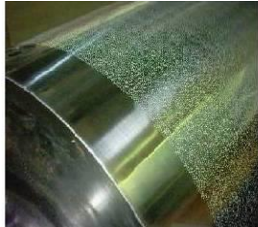
Planta aplicadora de hotmelts disponible en AITEX (izquierda) y cilindro aplicador grabado con puntos.
