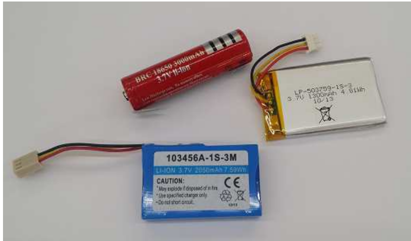
Fig.15: Diferentes baterías Ion-Litio y Pol-Litio
