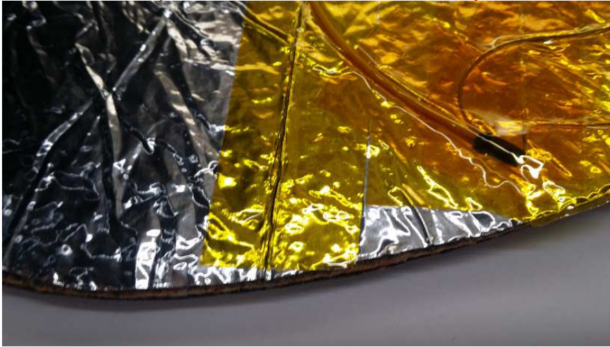
Fig.17: Resistencia y difusor de calor en el interior de la plantilla
