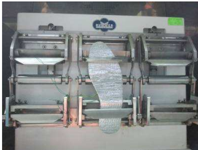
Fig.13: Ensayo UNE-EN ISO 17707 sobre plantilla sensorizada
