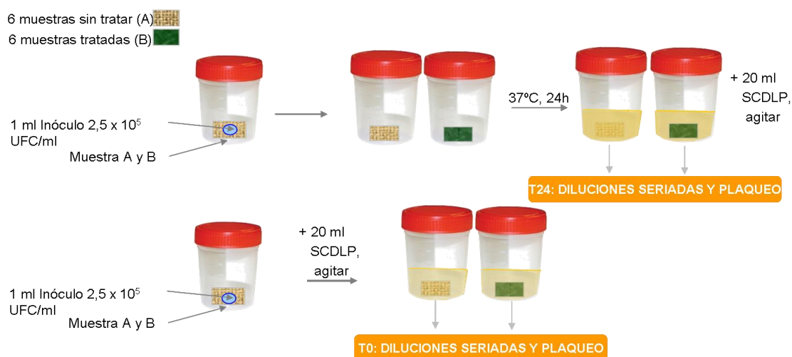
Figura 4 - Preparación de las muestras según norma ISO16187:2013.
