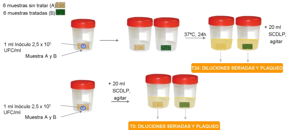
Figura 16 - Preparación de las muestras según norma ISO16187:2013.
