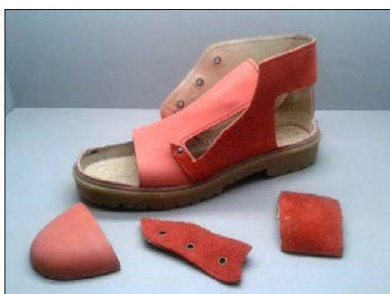
Figura 5. Despiece de zapato para ensayos
