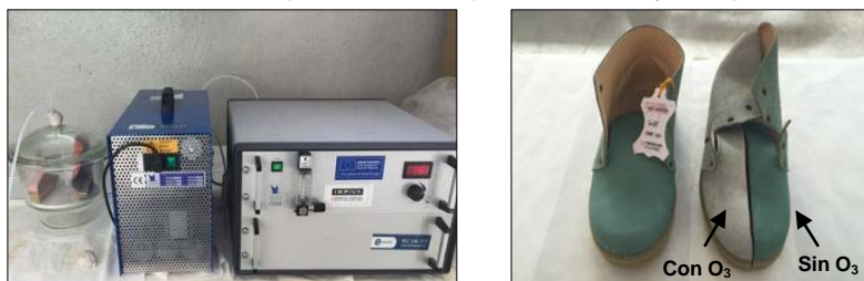
Figura 9. Ensayos de envejecimiento acelerado y aspecto de las muestras de calzado antes y después del tratamiento de ozonización
