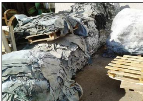
Figura 1. Almacén exterior de wet-blue en una tenería
